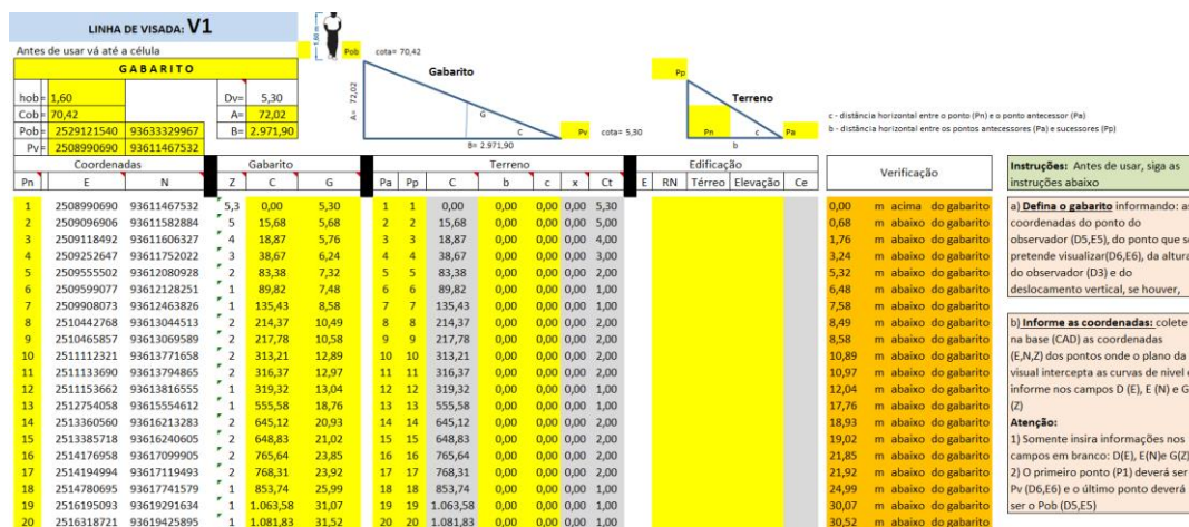
Figura 15 – Sistematização no programa Excel para cálculo de gabarito máximo a partir do gráfico elucidativo de triangulação
