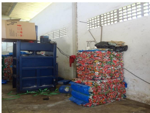
Figura 74. Enfardamento das latas de alumínio
